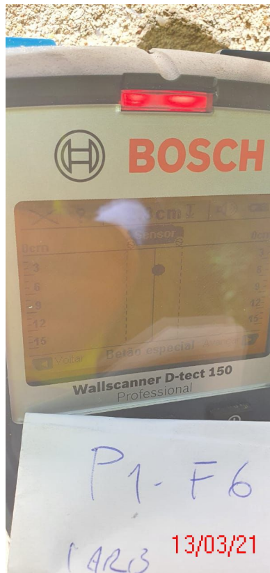
Figura 71 - leitura do cobrimento P1-F6=2,3cm
