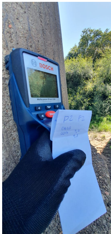
Figura 83 - leitura do cobrimento P2-F2=3,2cm
