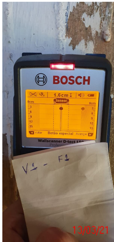
Figura 15 - leitura do cobrimento na longarina V1-F1=1,6cm
