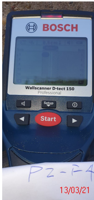
Figura 89 - leitura do cobrimento P2-F4=0,5cm
