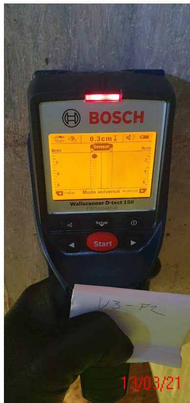
Figura 41 - leitura do cobrimento longarina V3-F2=0,3cm
