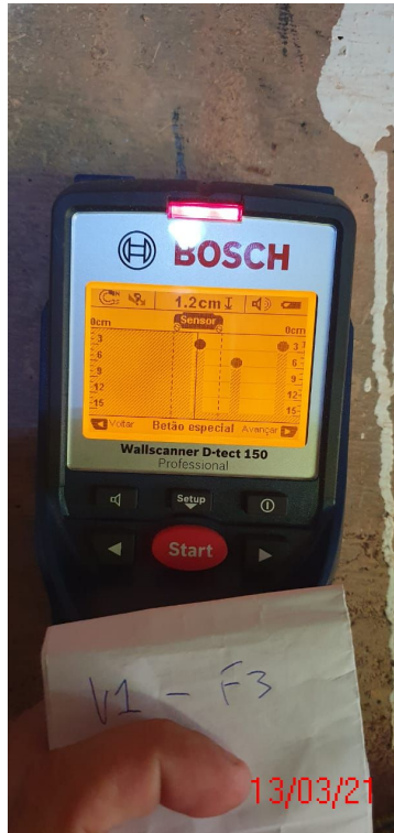
Figura 20 - leitura do cobrimento na longarina V1-F3=1,2cm
