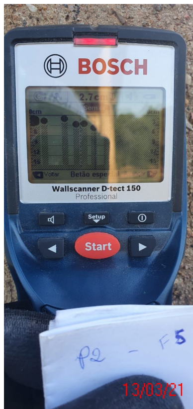
Figura 93 - leitura do cobrimento P2-F5=2,7cm
