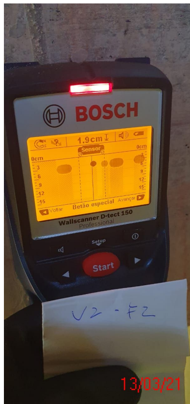
Figura 29 - leitura do cobrimento longitudinal V2-F2=1,9cm
