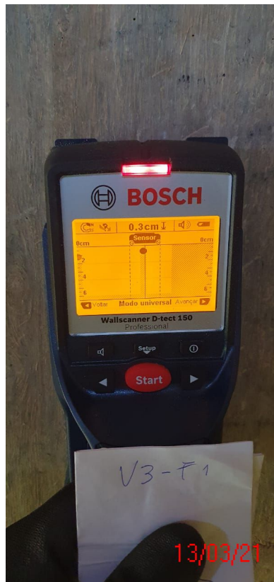
Figura 39 - leitura do cobrimento longarina V3-F1=0,3cm
