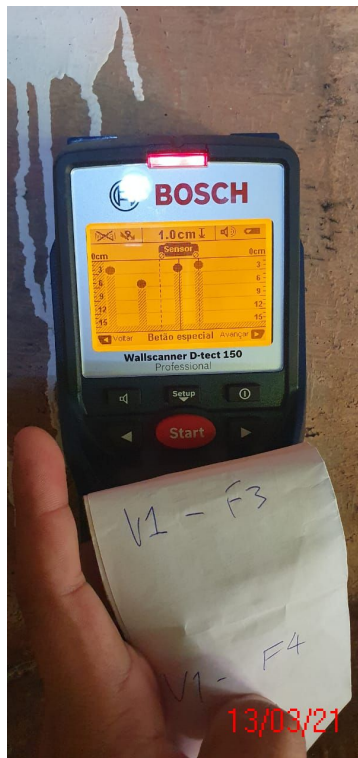
Figura 21 - leitura do cobrimento na longarina V1-F3=1,0cm
