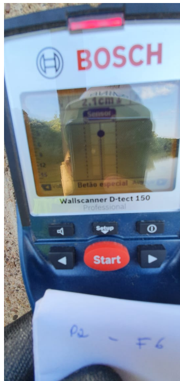
Figura 95 - leitura do cobrimento P2-F6=2,1cm
