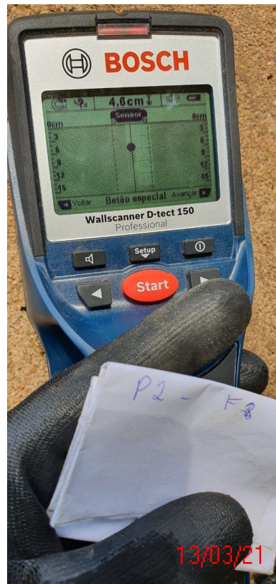
Figura 101 - leitura do cobrimento P2-F8=4,6cm
