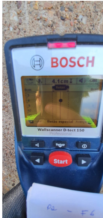
Figura 96 - leitura do cobrimento P2-F6=4,1cm
