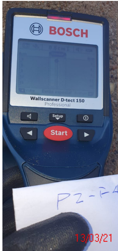
Figura 90 - leitura do cobrimento P2-F4=0,5cm
