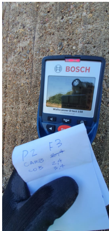
Figura 87 - leitura do cobrimento P2-F3=3,4cm
