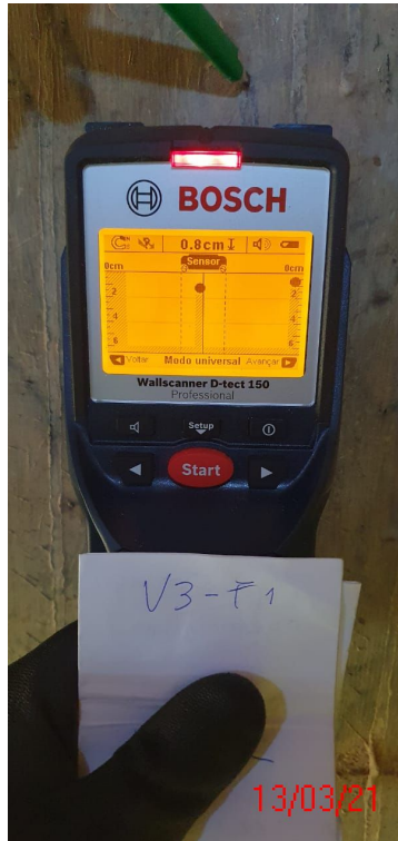
Figura 38 - leitura do cobrimento longarina V3-F1=0,8cm
