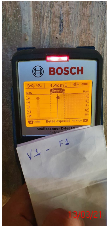
Figura 14 - leitura do cobrimento na longarina V1-F1=1,4cm
