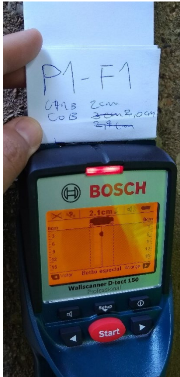
Figura 56 - leitura do cobrimento de concreto P1-F1=2,1cm
