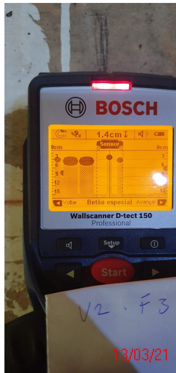
Figura 33 - leitura do cobrimento longarina V2-F3=1,4cm
