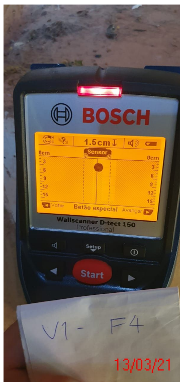
Figura 23 - leitura do cobrimento longarina V1-F4=1,5cm
