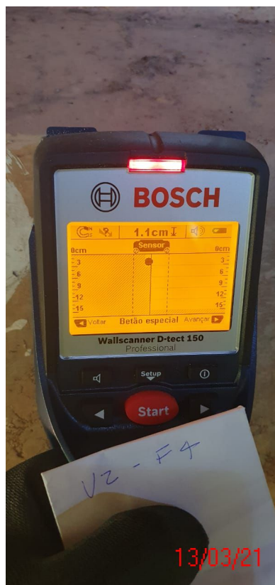
Figura 35 - leitura do cobrimento longitudinal V2-F4=1,1cm
