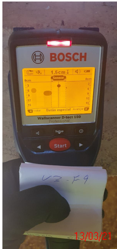
Figura 48 - leitura do cobrimento longitudinal V3-F4=1,5cm
