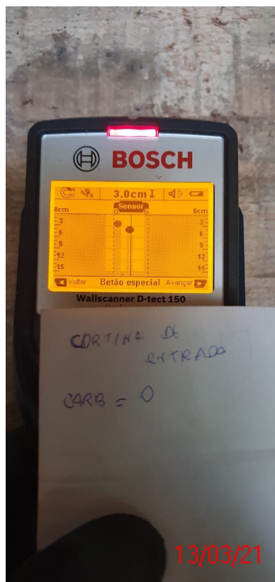
Figura 9 – leitura do cobrimento na cortina de entrada 01 – cob.=3cm
