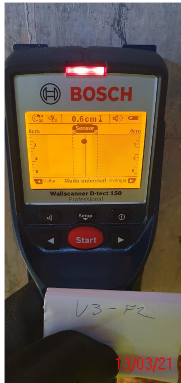
Figura 42 - leitura do cobrimento longitudinal V3-F2=0,6cm
